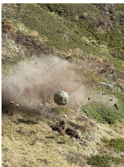
Experiment: Einer der Betonsteine rollt am Flüelapass den Hang hinunter. Bild Olivia Aebli-Item
