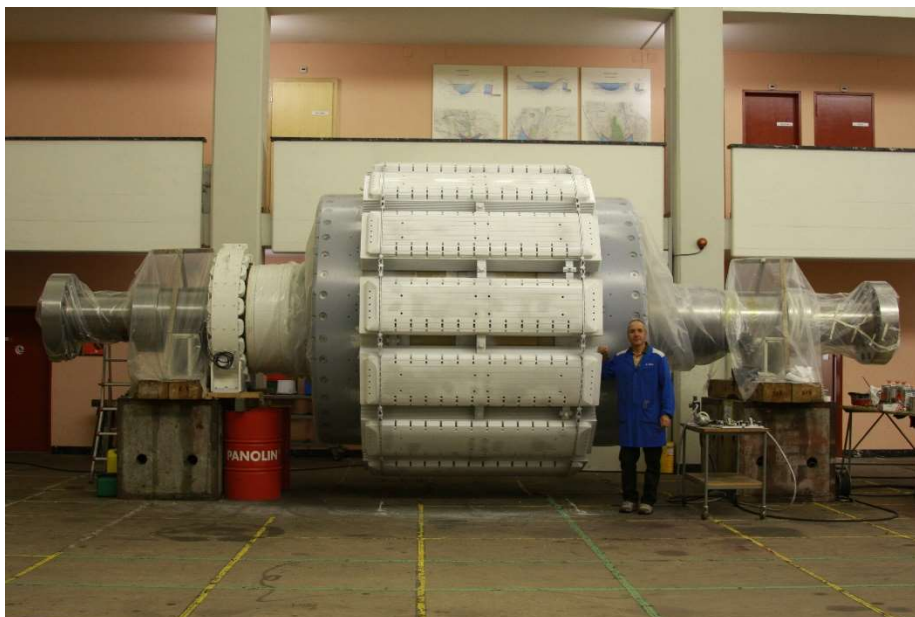
Rotor noch ohne Turbinen links und rechts, bereit für Einbau in der Kaverne
